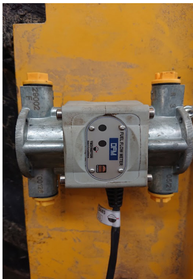
Slika 3. Diferencijalni mjerač protoka goriva – DFM 100CD
