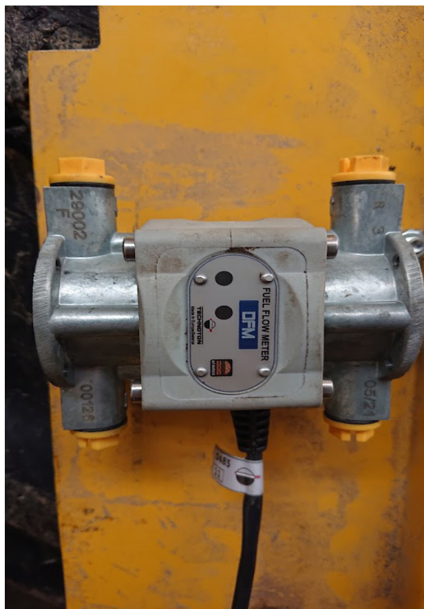
Slika 3. Diferencijalni mjerač protoka goriva – DFM 100CD
