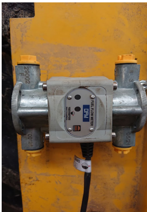
Slika 3. Diferencijalni mjerač protoka goriva – DFM 100CD
